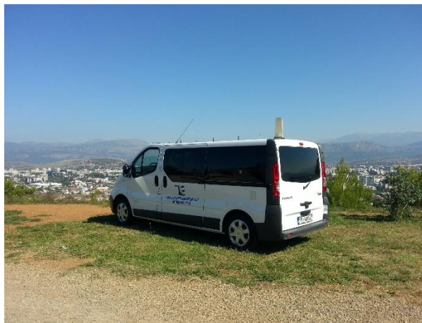
Mobilna kontrolno mjerna stanica (MKMS) u vozilu Renault® Trafic Passenger
